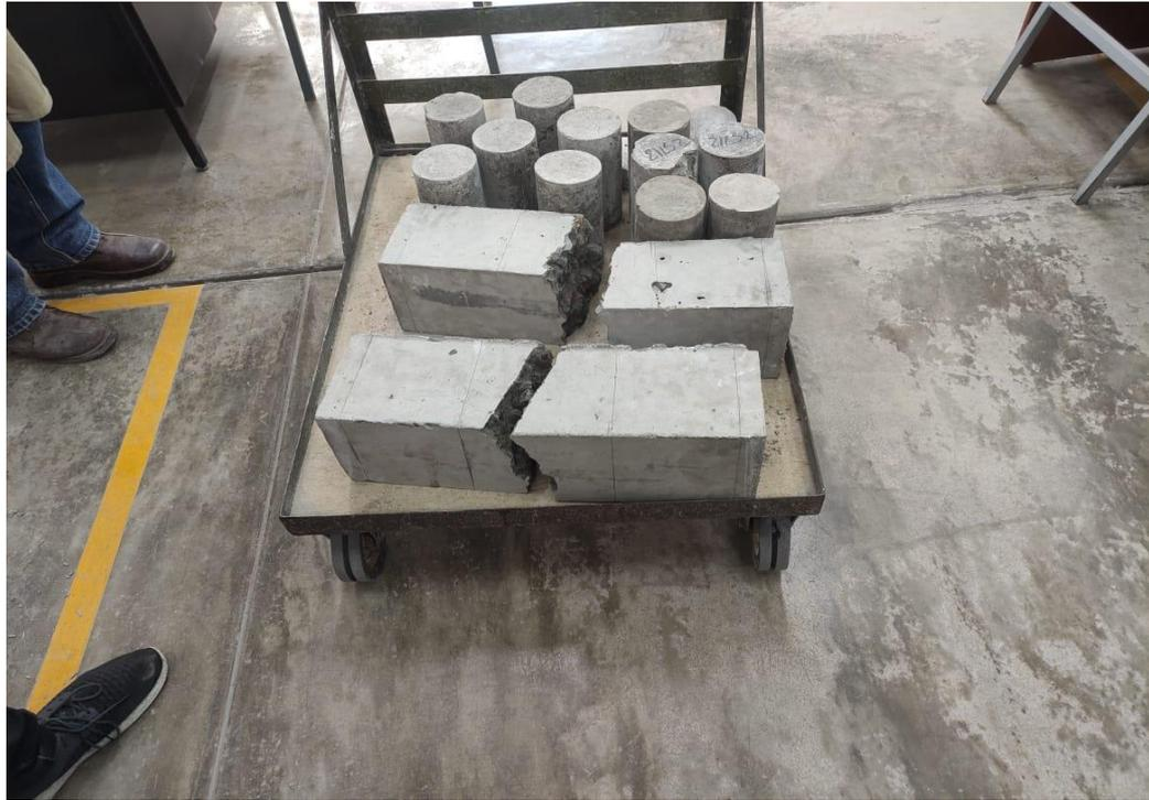
Figura 76. Rotura de vigas con porcentajes de 0% y 10% de lodos de Ptap.
