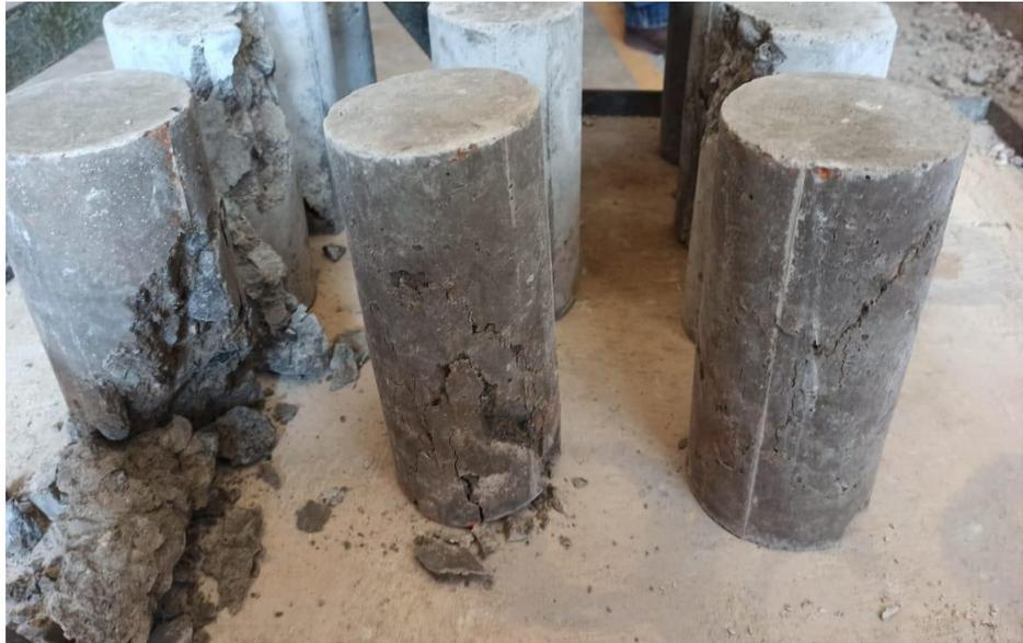
Figura 68. Rotura de probetas con 10% de lodos a los 14 días.
