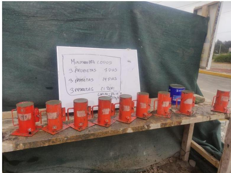
Figura 53. Probetas de concreto con 10% de Lodos en la mezcla.
