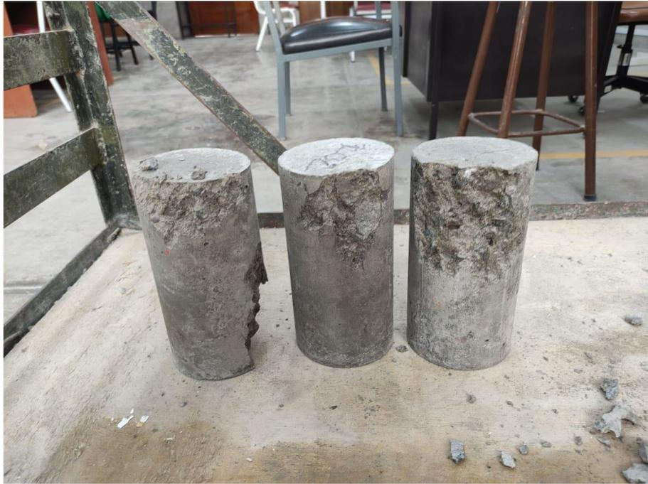
Figura 60. Rotura de probetas con 0% de lodos a los 7 días.
