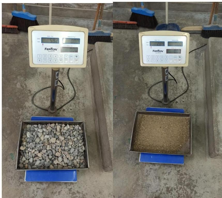
Figura 27. Peso del agregado grueso y agregado fino, para el contenido de humedad.
