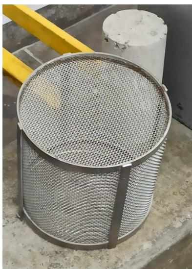
Figura 30. Canastilla para la balanza hidrostática.
