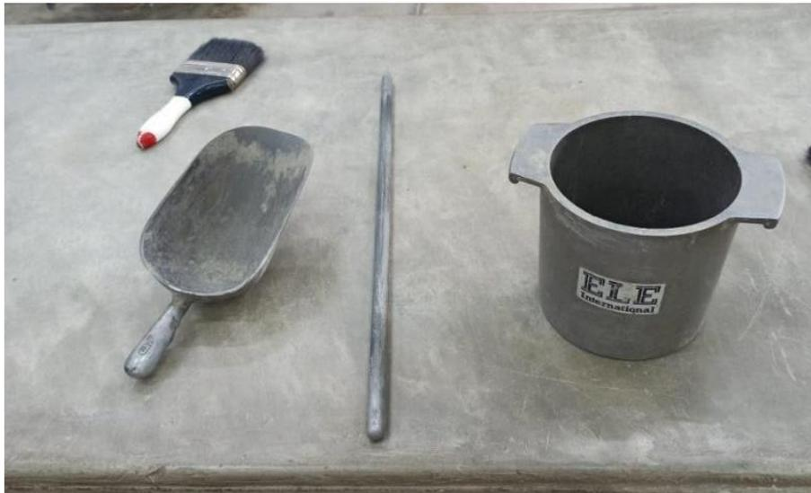
Figura 34. Materiales usados para determinar el peso unitario del agregado fino.
