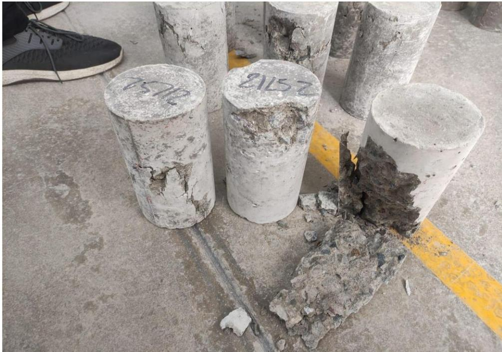
Figura 73. Rotura de probetas con 10% de lodos a los 21 días.
