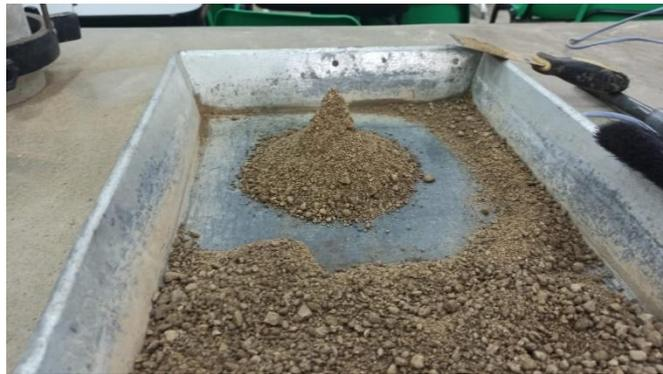
Figura 31. Verificación de la condición saturada superficialmente seca.
