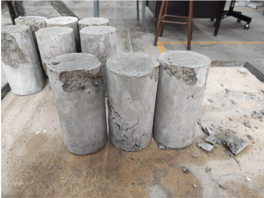
Figura 62. Rotura de probetas con 5% de lodos a los 7 días.
