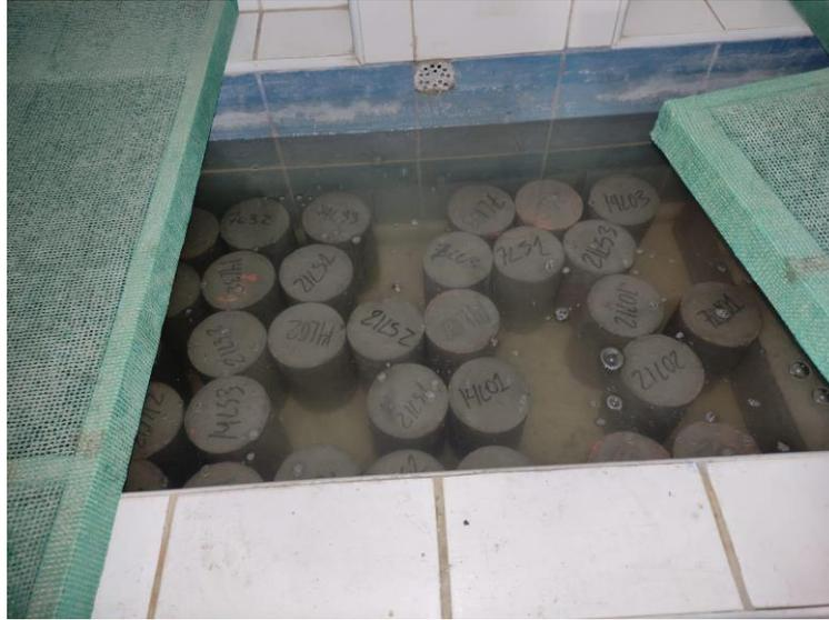
Figura 55. Curado de probetas en el laboratorio de ensayo de materiales.
