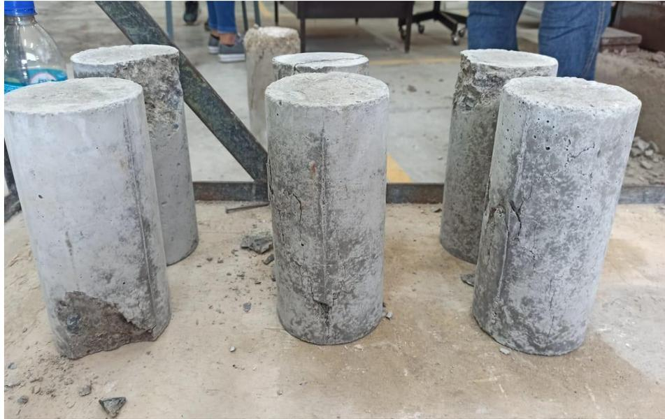
Figura 66. Rotura de probetas con 3% de lodos a los 14 días.
