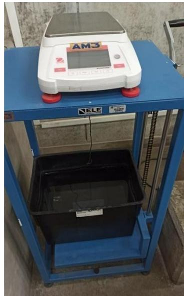
Figura 28. Balanza hidrostática, laboratorio de materiales, Universidad Ricardo Palma.
