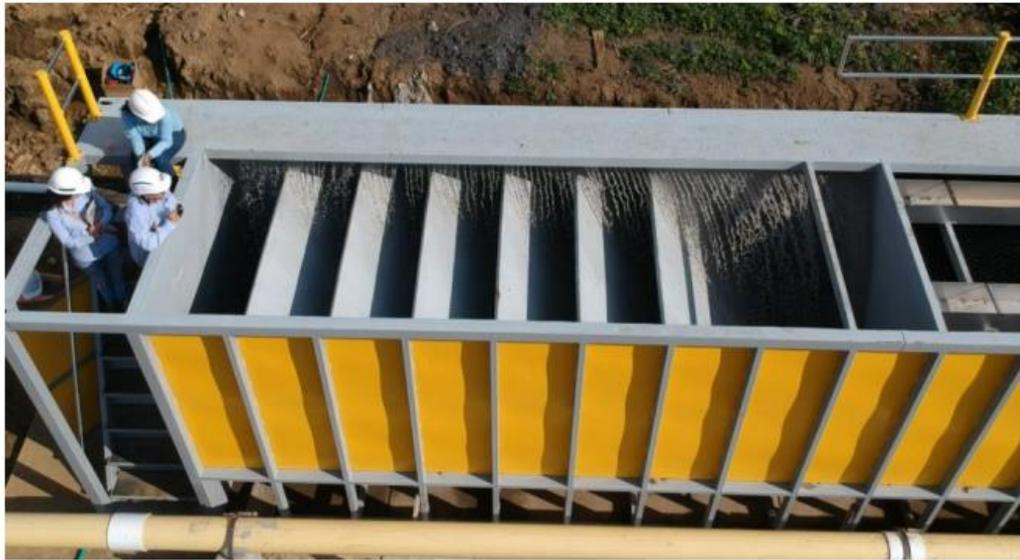
Figura 9. Planta potabilizadora de agua móvil.
