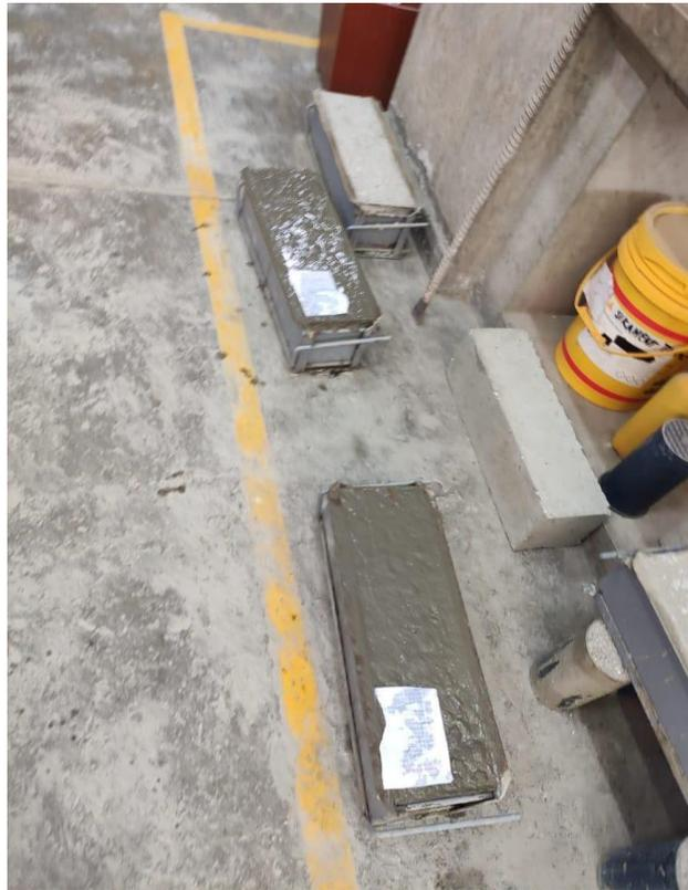
Figura 52. Vigas de concreto con 10% de lodos y 0% de lodos.
