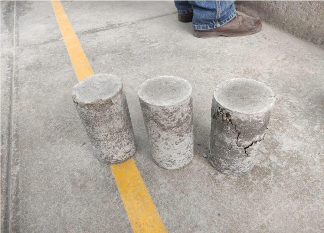
Figura 70. Rotura de probetas con 0% de lodos a los 21 días.
