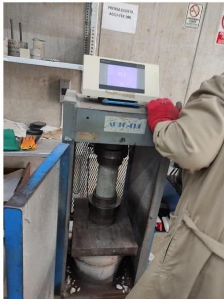
Figura 56. Prensa digital ACCU-500, laboratorio de materiales, U. Ricardo P.
