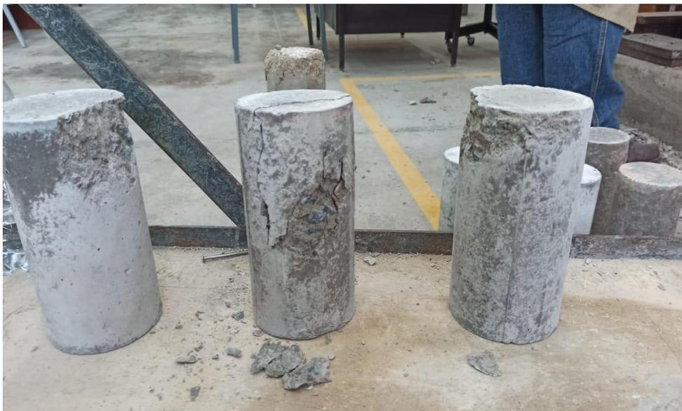
Figura 65. Rotura de probetas con 0% de lodos a los 14 días.
