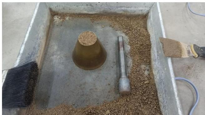
Figura 32. Cono y apisonador para la verificación del estado saturado superficialmente seco
