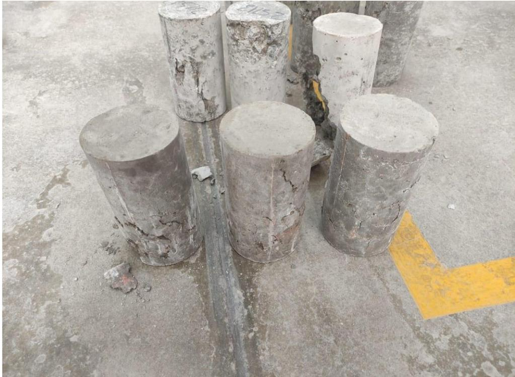
Figura 72. Rotura de probetas con 5% de lodos a los 21 días.
