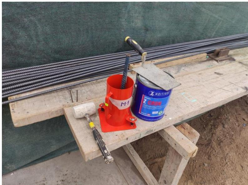
Figura 49. Materiales empleados en la elaboración de los testigos.
