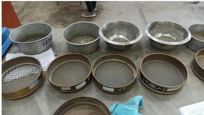
Figura 25. Material retenido en las mallas para la granulometría fina.
