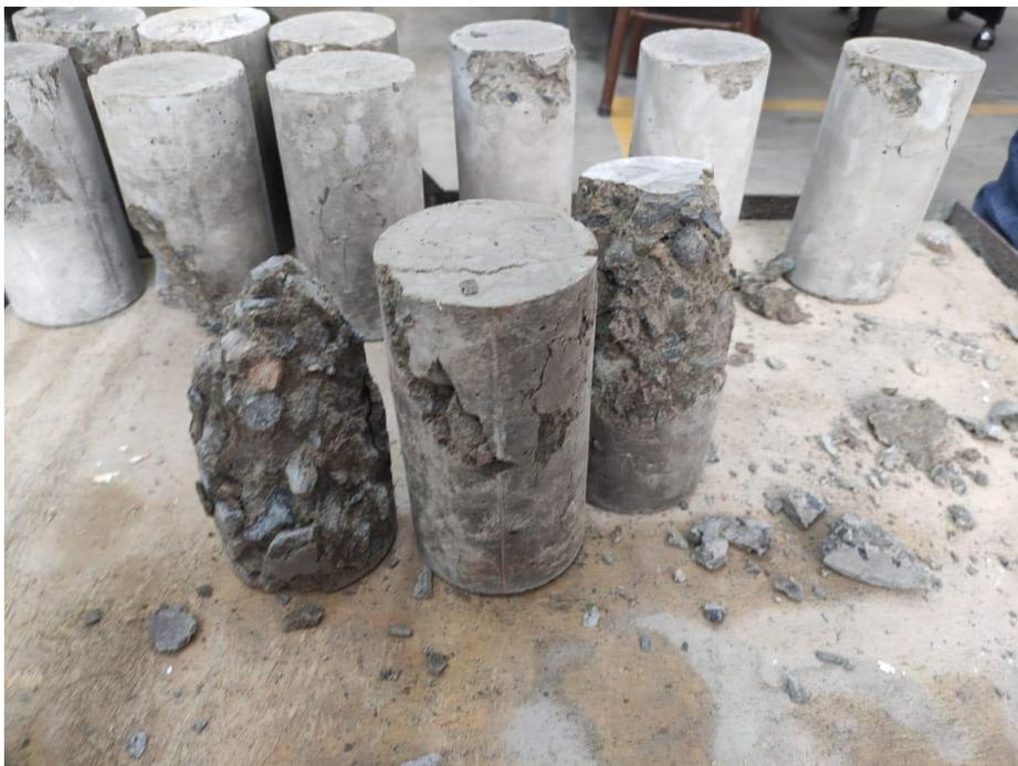
Figura 63. Rotura de probetas con 10% de lodos a los 7 días.
