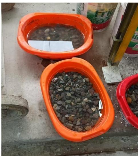
Figura 29. Saturación del agregado grueso durante 24 hrs.
