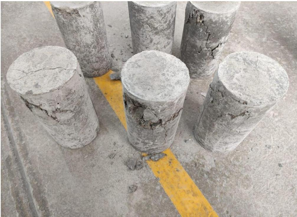
Figura 71. Rotura de probetas con 3% de lodos a los 21 días.
