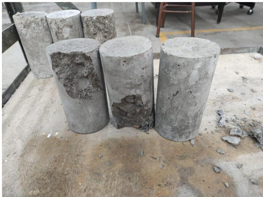
Figura 61. Rotura de probetas con 3% de lodos a los 7 días.
