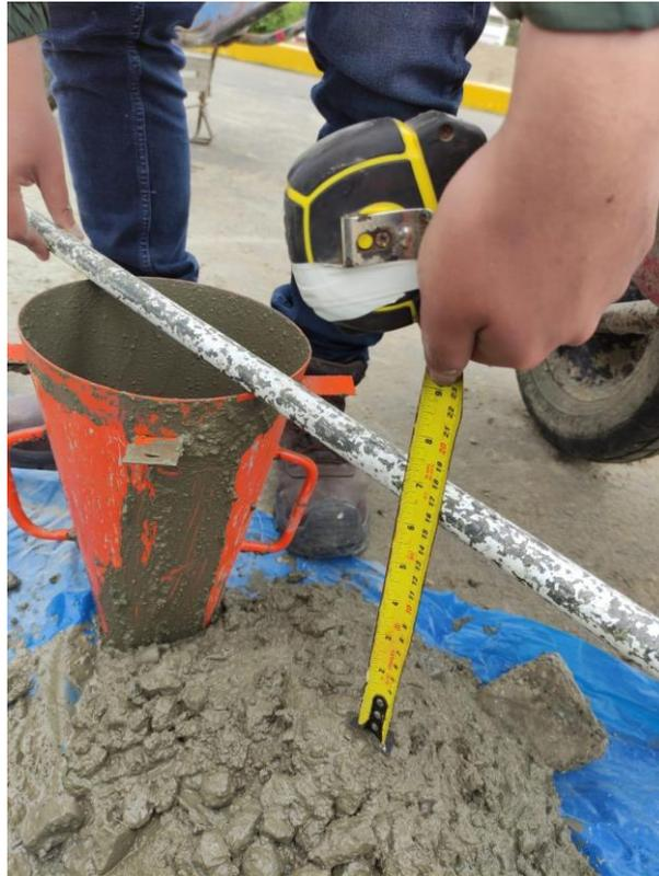
Figura 50. Ensayo del Cono de Abrams
