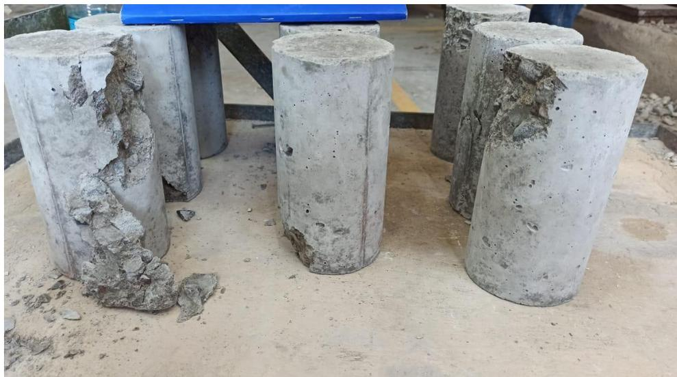
Figura 67. Rotura de probetas con 5% de lodos a los 14 días
