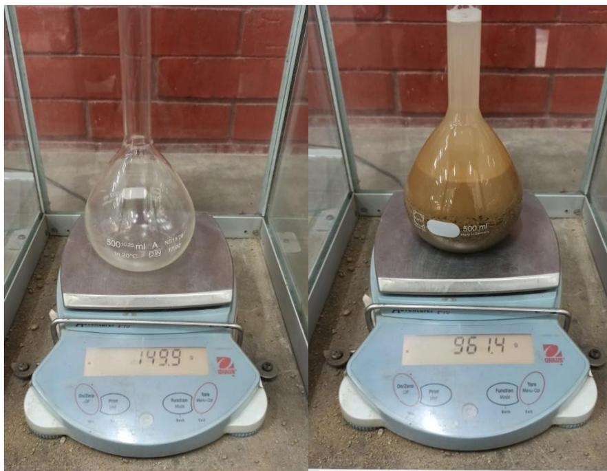
Figura 33. Peso de la fiola vs peso de la fiola con muestra de agregado fino.
