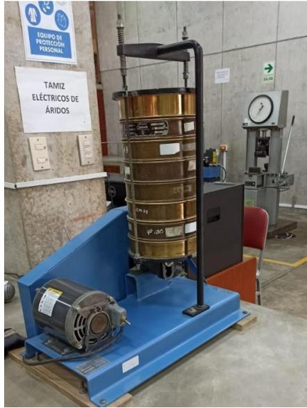
Figura 24. Agitador mecánico para tamices.
