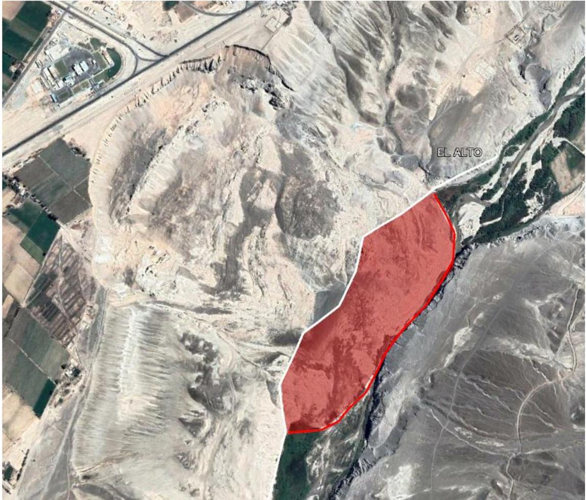
*Figura N 28:* Área del cauce obstruida por el deslizamiento
