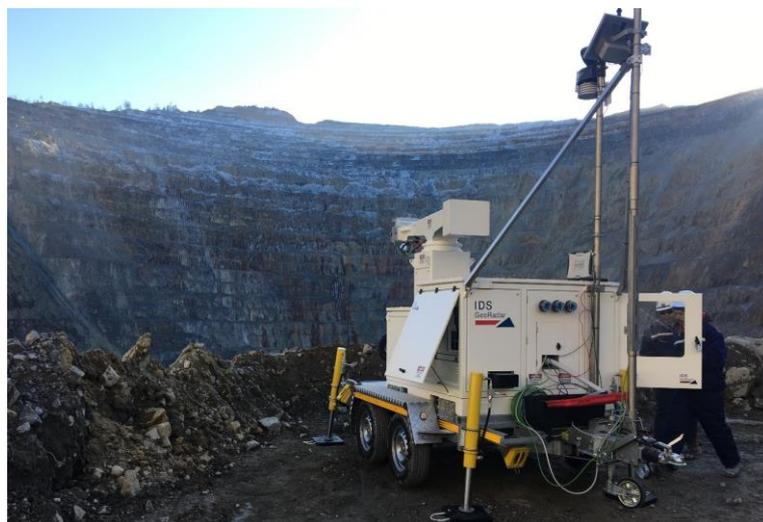
*Figura N 9:* Uso de radares de estabilidad de taludes (SSR).
