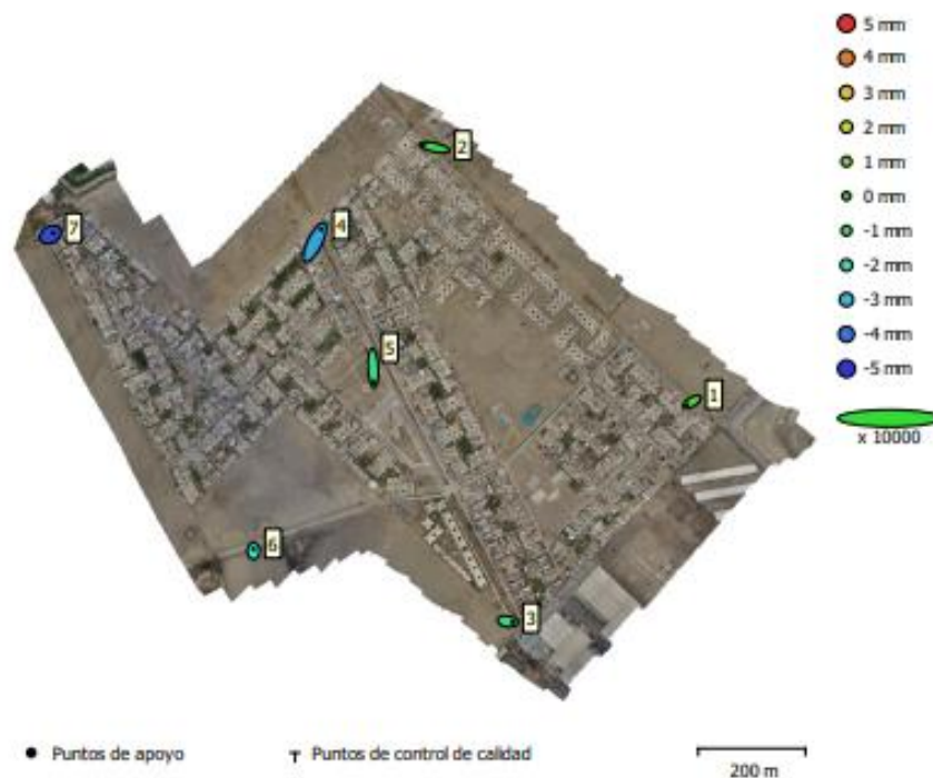
Fig. 4. Posiciones de puntos de apoyo y estimaciones de errores. El color indica el error en Z mientras el tamaño y forma de la elipse representan el error en XY. Las posiciones estimadas de puntos de apoyo se marcan con puntos o cruces.
