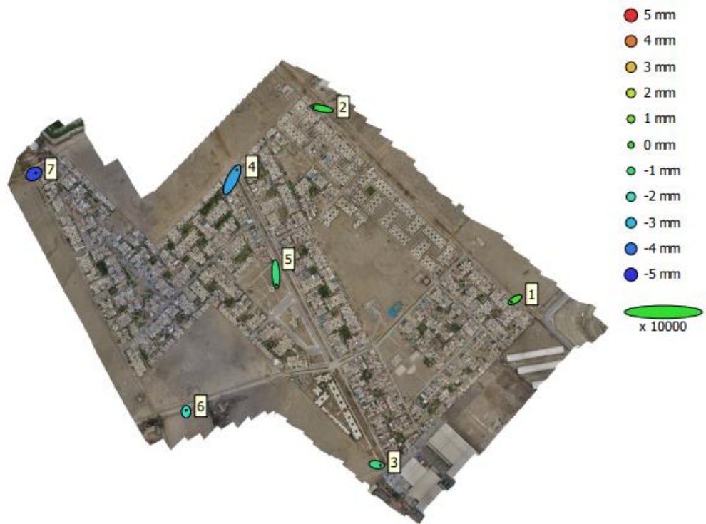
Figura 33: Puntos de control terrestre. Fuente: Elaboración propia.
