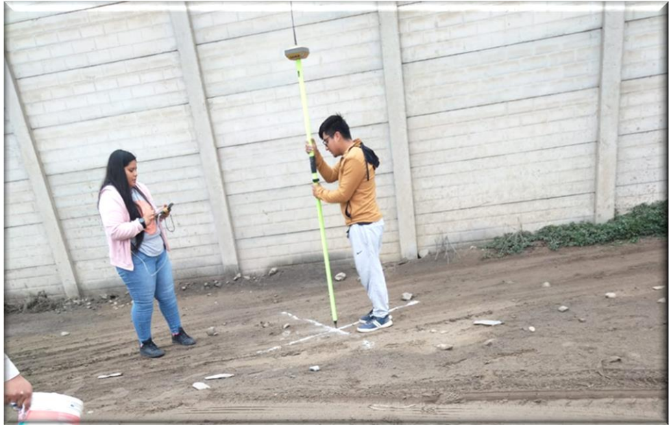
Figura 53: Levantamiento de puntos de referencia Fuente: Elaboración Propia.
