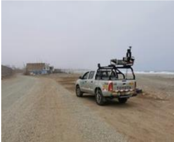
Figura 17: Inicio del recorrido con el sistema IP-S2 Fuente: Elaboración propia.
