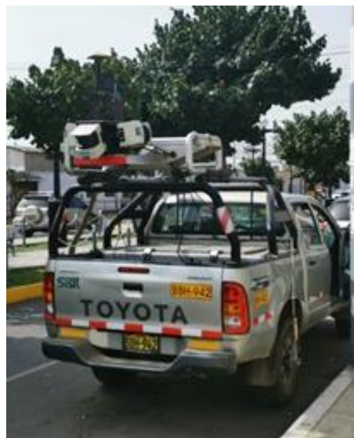
Figura 16:Scanner móvil IP – S2. Fuente: Elaboración propia.
