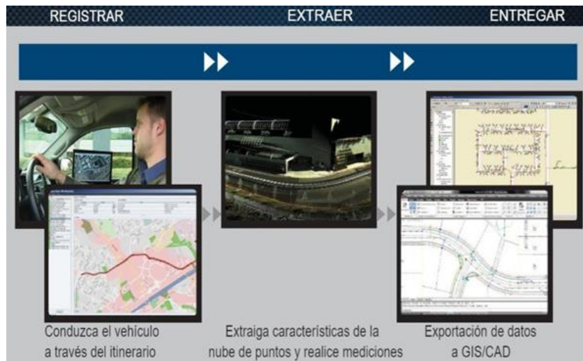
Figura 11: Proceso de uso de Scanner LiDAR IP-S2. Fuente: Topcon (2012).
