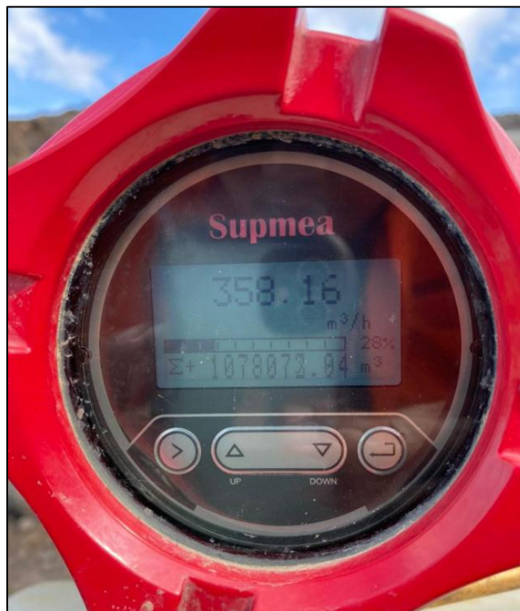
Gambar 8. Hasil pengukuran debit slurry pump di alat ukur debit flowmeter
