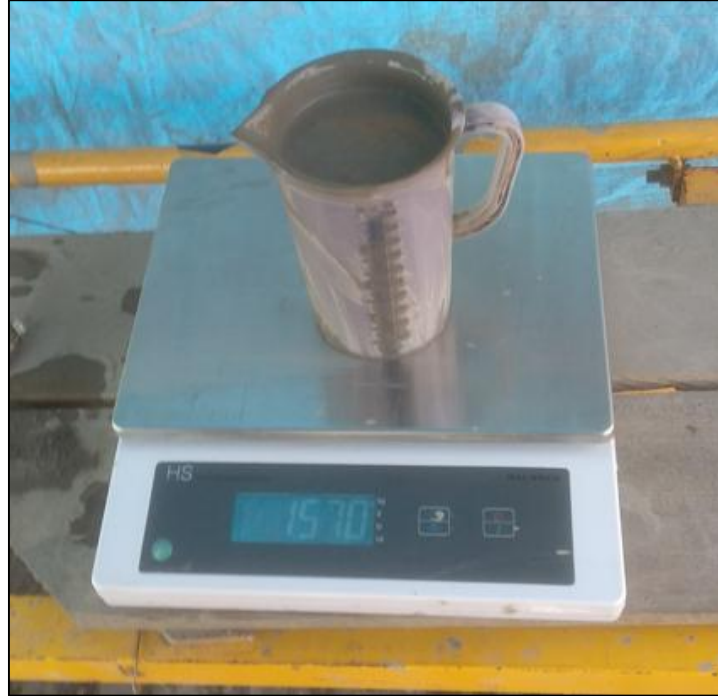
Gambar 9. Pengukuran dan penimbangan S.G material slurry
