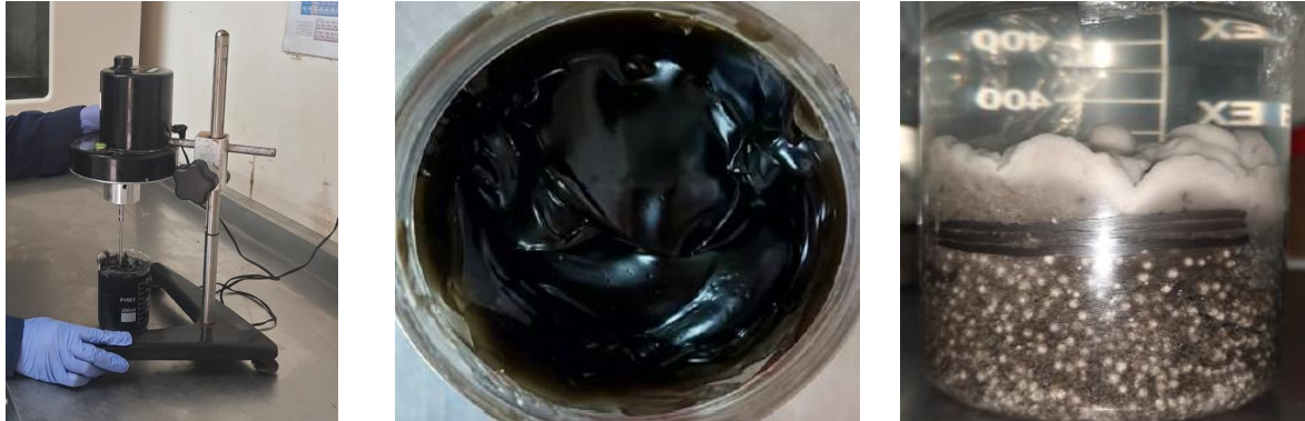
Gambar 10. Pengamatan viskositas emulsi, stabilitas emulsi, dan ketahanan S300 Eco DRN100 terhadap penetrasi air.
