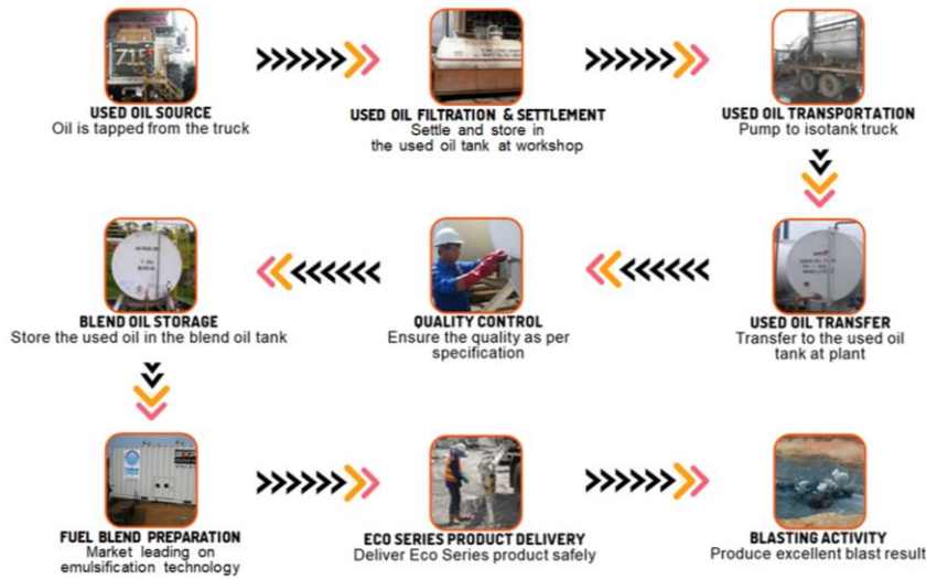
Gambar 4. Alur proses used oil dari sumber hingga pemakaian akhir pada bahan peledak.
