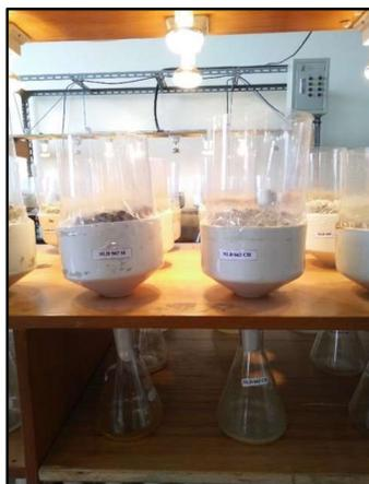
Gambar 2. Uji Kinetik dengan Metode *Free Draining Column Leach Test*.
