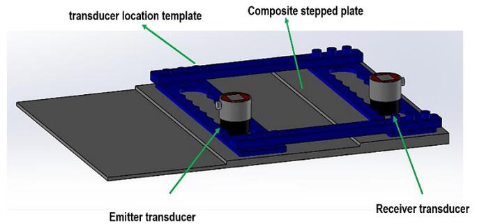
Figura 3. Ubicación de los transductores ultrasónicos. Fuente: Autores.
