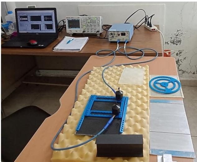
Figura 2. Desarrollo experimental de la inspección de materiales compuestos. Fuente: Autores.
