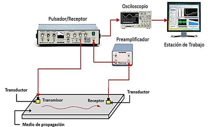
Figura 1. Equipo de generación y adquisición de ondas ultrasónicas. Fuente: Autores.
