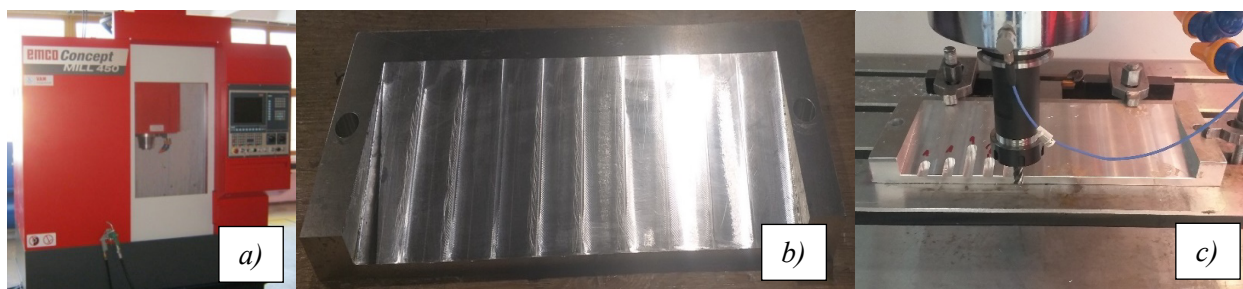
Slika 3 a) Obradni centar EMCO Concept Mill 450; b) pripremak od aluminijuma Al7075; c) pozicija senzora ubrzanja pri eksperimentalnom ispitivanju samopobudnih vibracija
