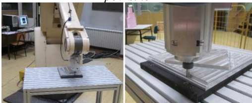
Слика 5.3 Obrada konture kvadrata test radnog dela na robotu LOLA50
