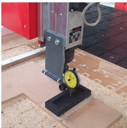
Slika 5. Merenje epruvete komparaterom uz pomoć CNC mašine
