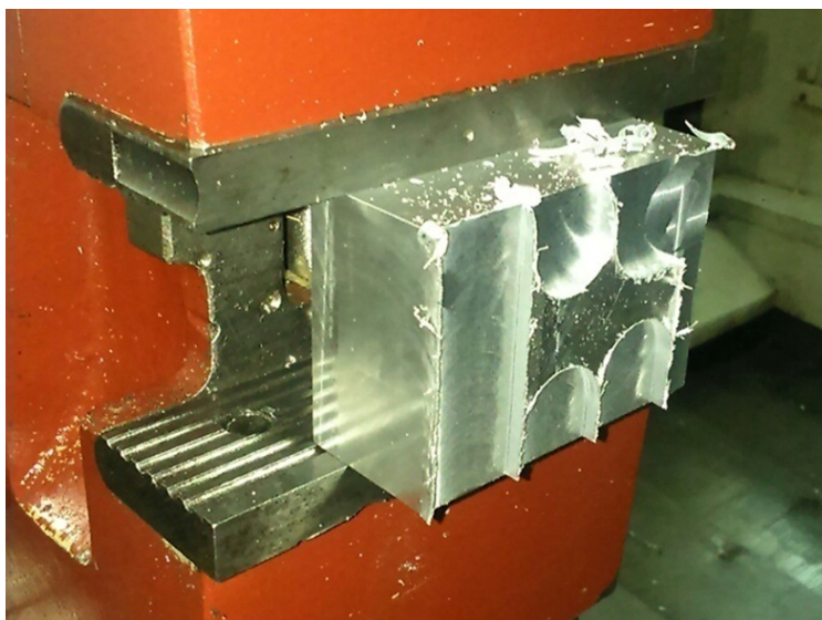
Slika 6. Izradak nakon sprovedenog zahvata predobrade čeonim vretenastim glodalom [7]
