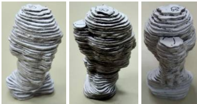
Slika 3.4 Model dobijen lepljenjem slojeva kartona
