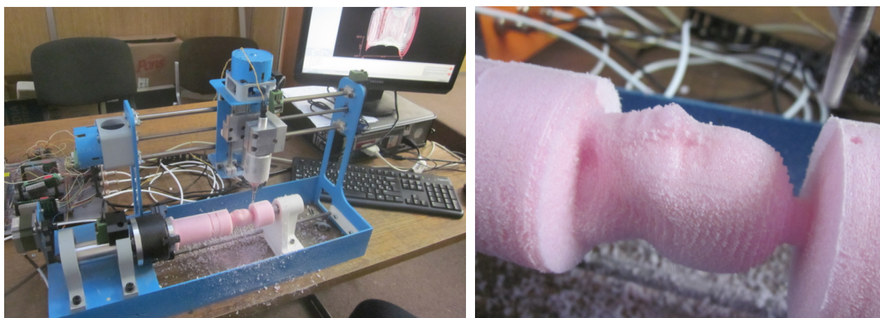
Slika 6.1 Obrada na stonoj troosnoj mašini strukture A'OXZ
