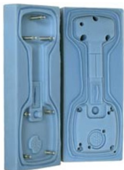
Slika 7. Kalupi sa metalnim umecima izrađeni ACES postupkom [13]
