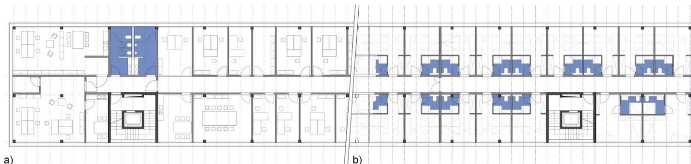
**Bild 6** Möglichkeiten zur Grundrissgestaltung bei einem Zweibundsystem: a) offene Bürostrukturen und Zellenstrukturen, b) Beherbergungsstätte
