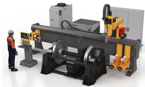
Рис. 2. Установка обработки тел вращения FL-CPM [выполнено авторами].
