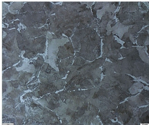
Рис. 1. Микроструктура основного металла колёсной стали 2, \times 1000 [выполнено авторами].
