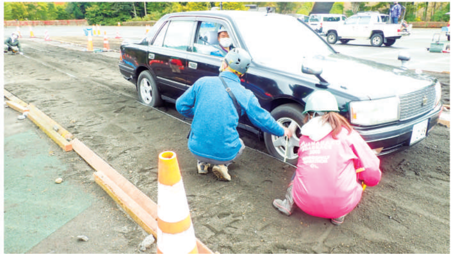
写真1 降灰路における走行実験 Aコースで制動距離を測定している様子
