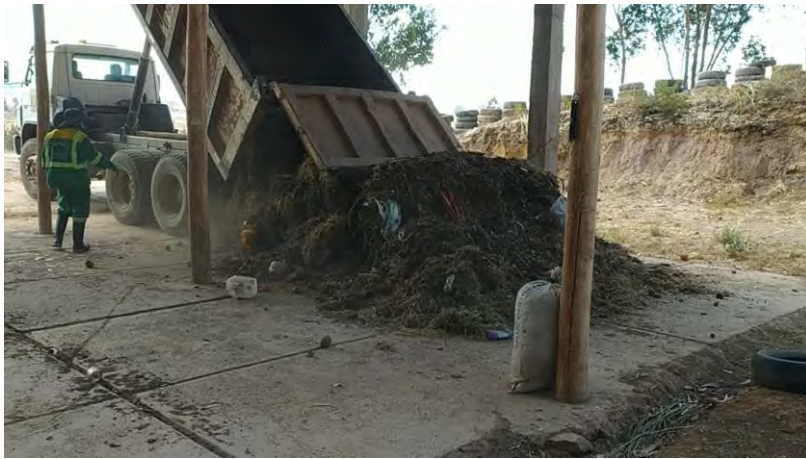
Foto 5. Descarga de residuos sólidos orgánicos municipales en la planta de compostaje de la Municipalidad Provincial de Anta
