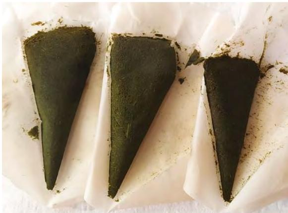
➤ **Molienda:** Posterior al secado se realizó la molienda de las muestras del Biosorbente Activado (BA) como muestra la Figura 16.
