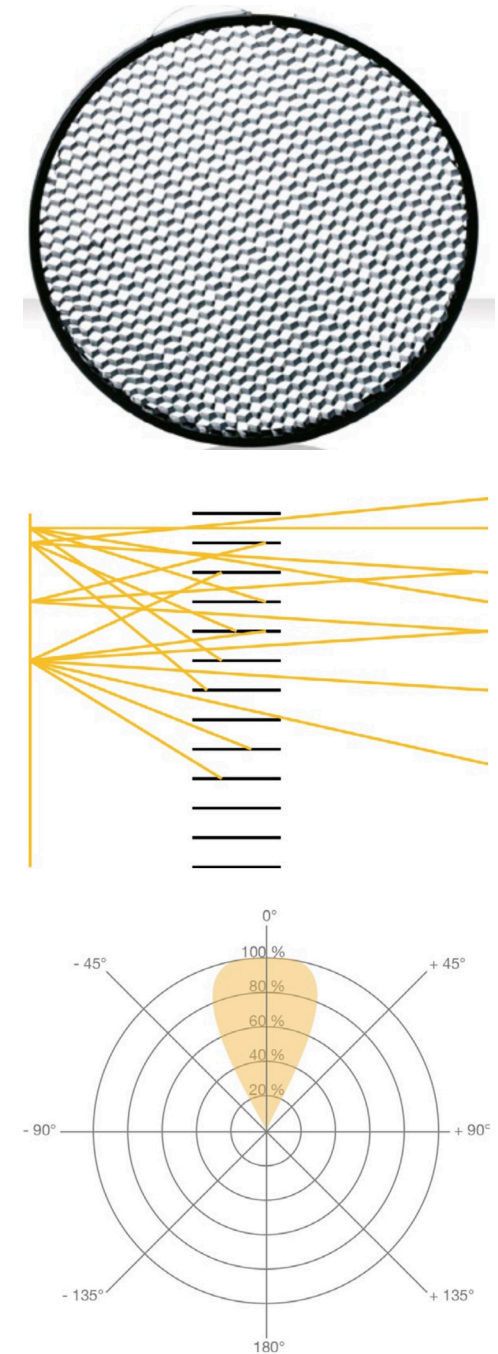
Abbildung 2.2 Abstrahlcharakteristik eines Normalreflektors unter Verwendung eines Grids (Entnommen aus Rausch, 2021, S. 115 f).
