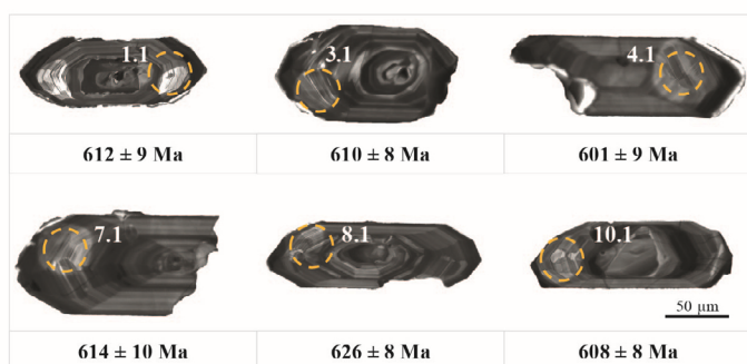
Figura 11. (A) Imagens de catodoluminescência dos cristais de zircão utilizados para o cálculo da idade U-Pb SHRIMP do stock Mocambo (SOS-645). Os valores apresentados correspondem às idades obtidas em cada cristal. Os círculos amarelos indicam a área da posição do spot. (B) Diagrama Concórdia U-Pb para os cristais de zircão (SOS-645) do stock Mocambo.
