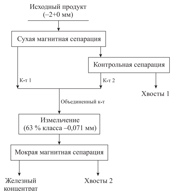
Рис. 2. Схема получения железорудного концентрата с мокрой магнитной сепарацией
