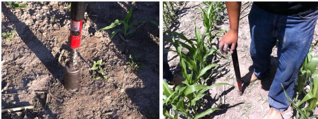
**Figura 11 (izquierda). “Soil Core Sampler”. Figura 12 (derecha). Toma de muestras con el “Soil Core Sampler” sobre la huella del tractor para su análisis en laboratorio.**
