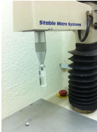
**Figura 13. Sonda para la prueba de CUD montada en la máquina universal de prueba.**
