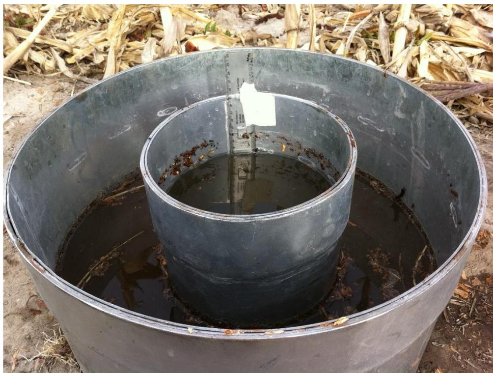
**Figura 18. Infiltrómetro de doble cilindro utilizado para determinar la velocidad media de infiltración del agua en el suelo.**
