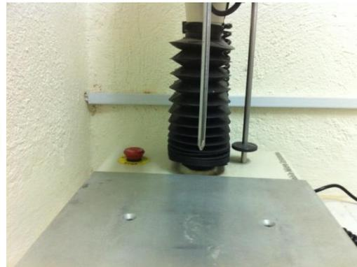
**Figura 14 (izquierda). Representación de la punta de la sonda utilizada para la prueba de  $R_p$  en laboratorio. Figura 15 (derecha). Sonda de  $R_p$  montada en la máquina universal de prueba.**
