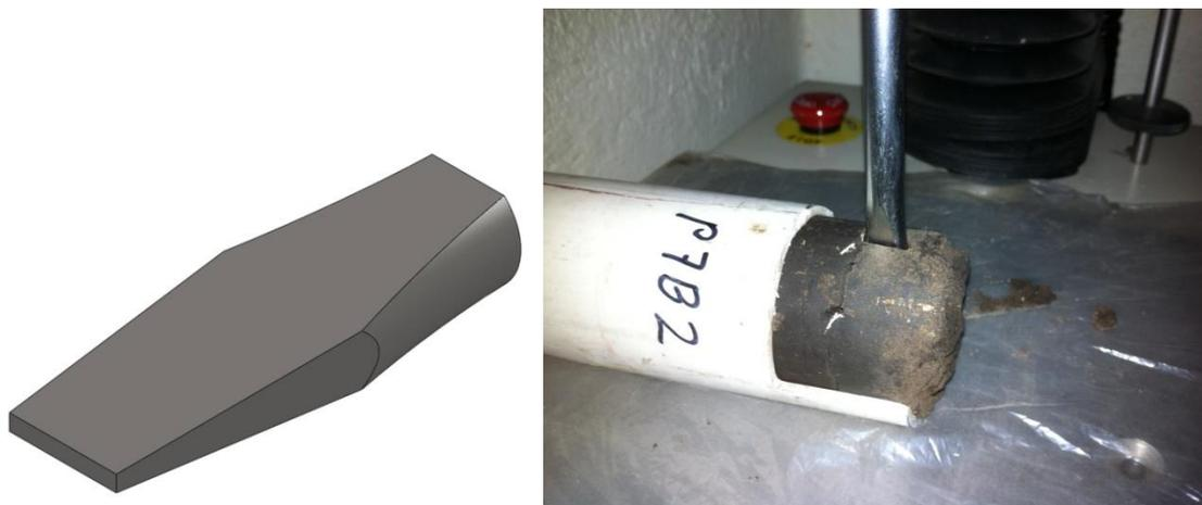
**Figura 16 (izquierda). Representación de la punta de la sonda utilizada para la prueba de  $F_c$  en laboratorio. Figura 17 (derecha). Muestra dispuesta horizontalmente para la prueba de fuerza de corte.**
