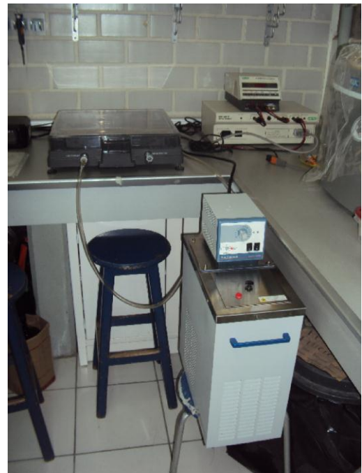
Figura 10. Equipo empleado para la PFGE, incluyendo la cámara de electroforesis CHEF DRII (Fuente: Datos originales)
