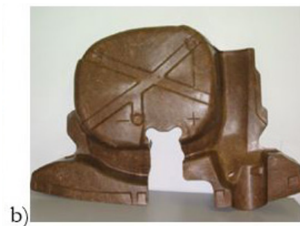
Figura 5. Mercedes Benz Clase A (a) y bajo alfombra de PP con la fibra de plátano (b)
