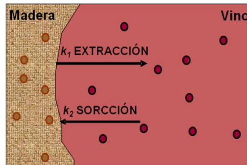
Figura 1. Esquema que ilustra la transferencia de materia de un compuesto de aroma entre el vino y la madera (Adaptado de Ferreira et al. 2006).
