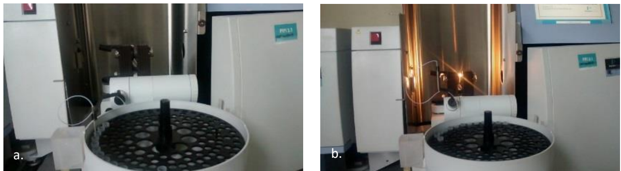
Fig. 7 Equipo funcionando: a. Toma de muestra en microlitros, b. Horno de grafito generando calor
