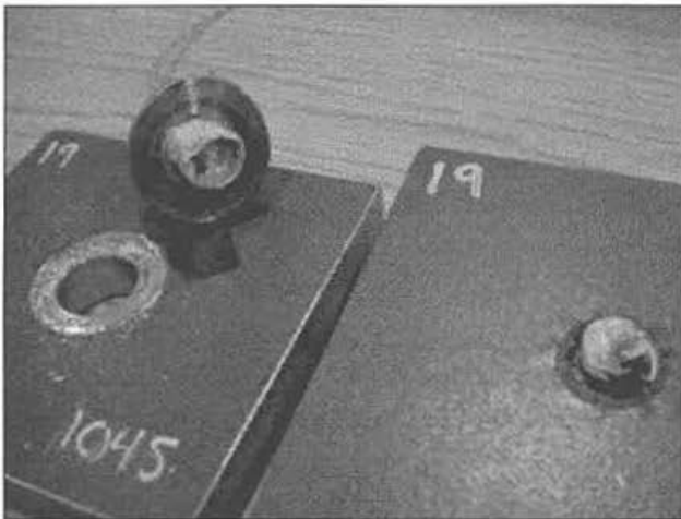
Figura 7 FRACTURA DE TORNILLO EN ACERO SAE 1045
