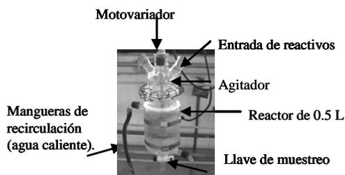
Figura 1. Equipo utilizado para realizar las escalaciones.
