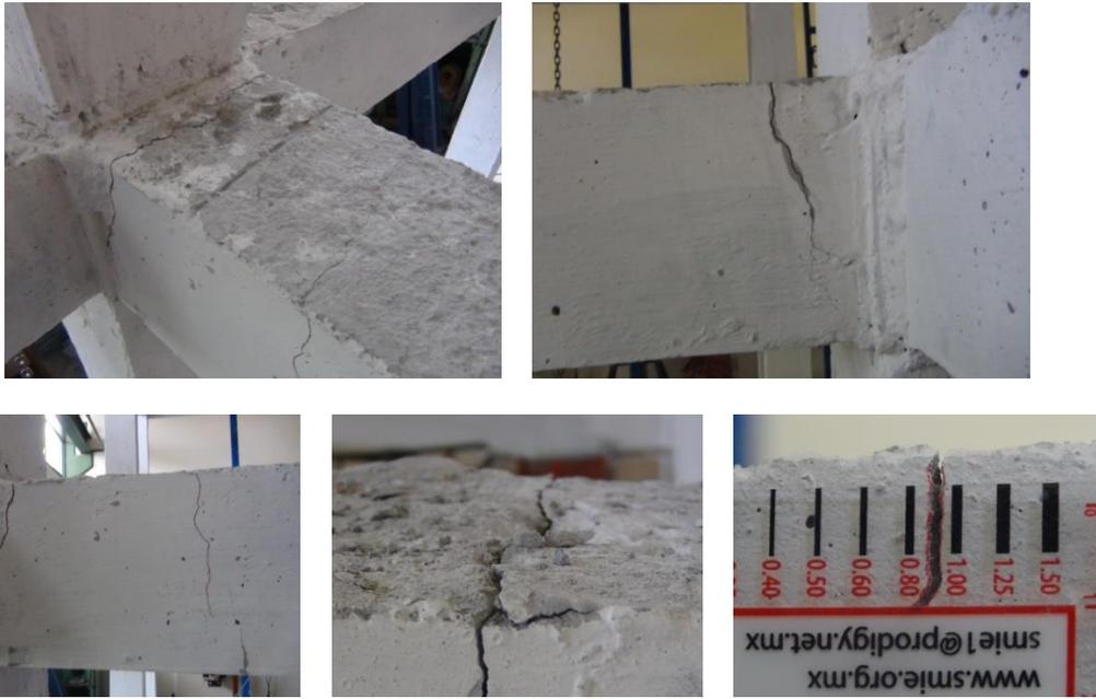
a) Prueba  $N = 6$ ,  $\gamma_{max} = 0.0025$  (inicio de fluencia)
