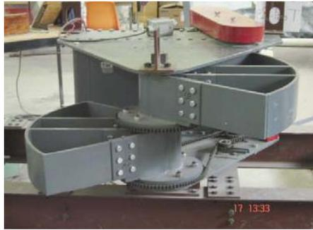
Figura 1. Excitador de masas excéntricas sujeto a la plataforma del péndulo de prueba
