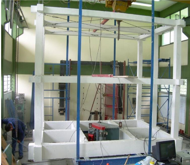
Figura 3. Péndulo de prueba junto con el modelo de concreto reforzado que se estudia
