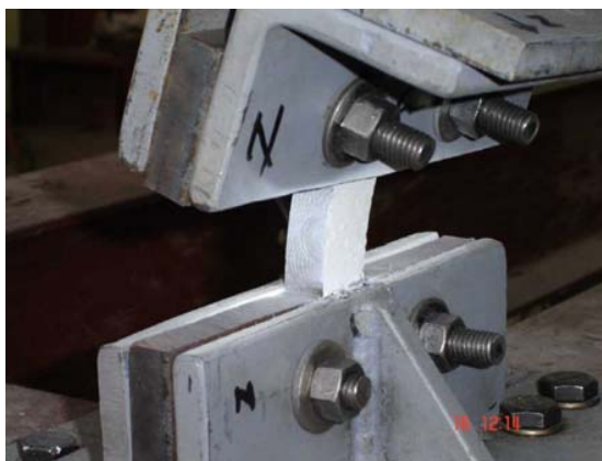
Figura 6. Placa de control en estado de falla.
