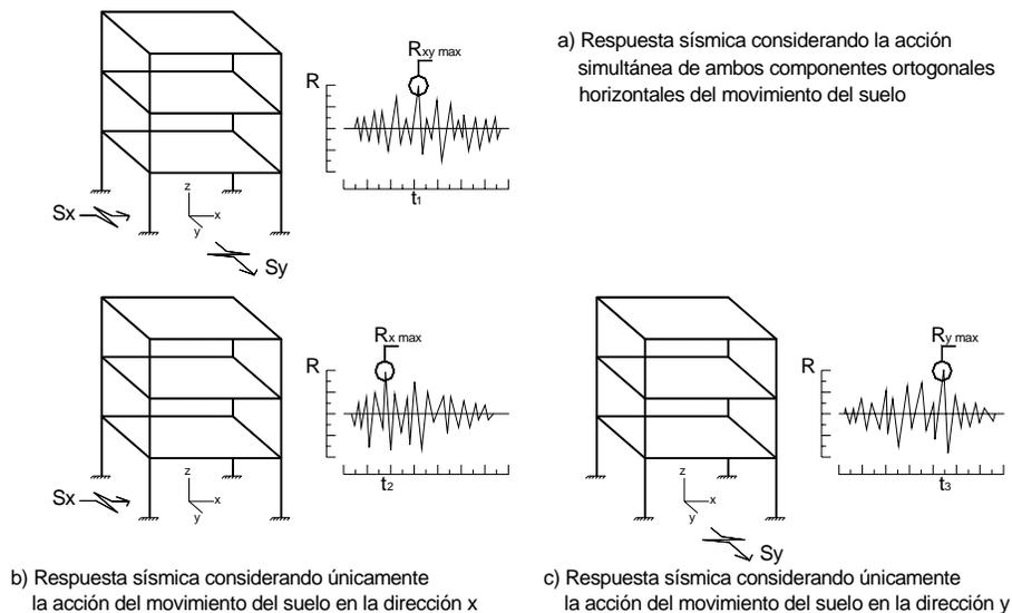
Figura 1. Respuesta sísmica unidireccional y bi-direccional
