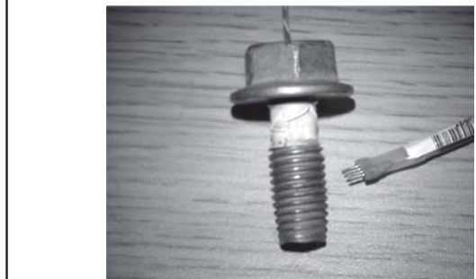
Figura 2. Tornillo autorroscante instrumentado con galgas extensiométricas.
