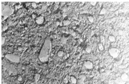
Cuadro 1. Grupo de fotografías 1) Las microestructuras en estado recocido R (con un aumento de 5,000 x-microscopio electrónico). Obtenidas con base en diferentes tecnologías
