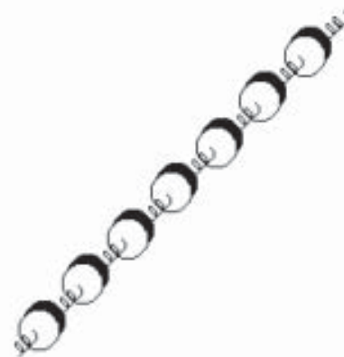
Figura 4. Cadena de discos acoplados por medio de un resorte que vibra tanto longitudinal como rotacionalmente, conocida como grano-resorte (elaboración propia).
