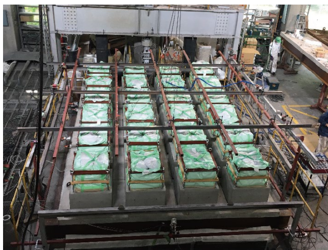
図 3.2.1 平島らが行った载荷加熱実験
