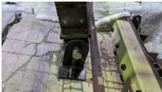
図 4.2.17 鉛直ジャッキと試験体の接合部
