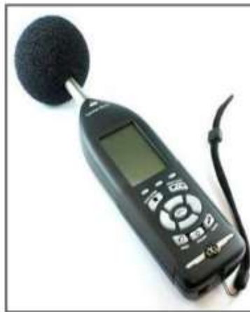
Fig. 21 Sonómetro Larson LXT-1
