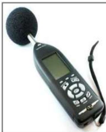
Fig. 43 Sonómetro Larson LXT-1
