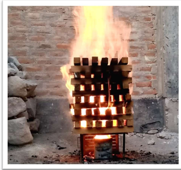
Figura 44: Desprendimiento de Brasas Prueba 4
