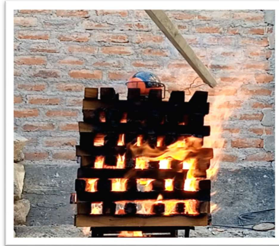
Figura 39: Colocación de Bola de Extinción de Incendios Prueba N°3
