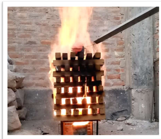
Figura 45: Colocación de Bola de Extinción de Incendio Prueba N° 4
