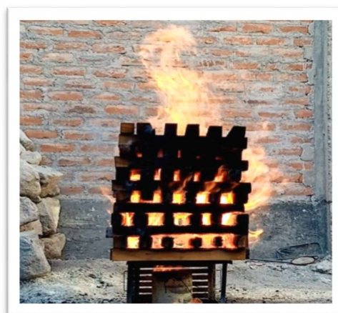
Figura 38: Quemado y desprendimiento de brasas Prueba N° 3
