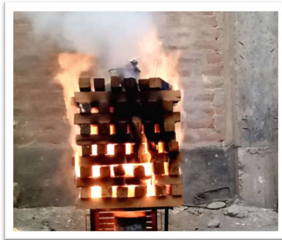
Figura 47: Post Activación de la Bola de la Extinción de Incendios
