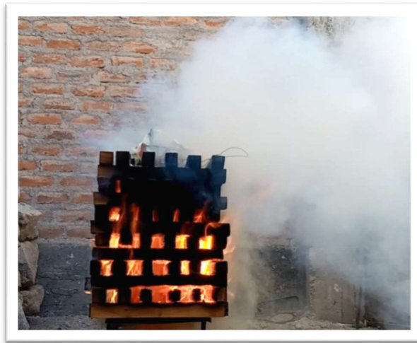
Figura 41: Post activación de Bola de Extinción de Incendios
