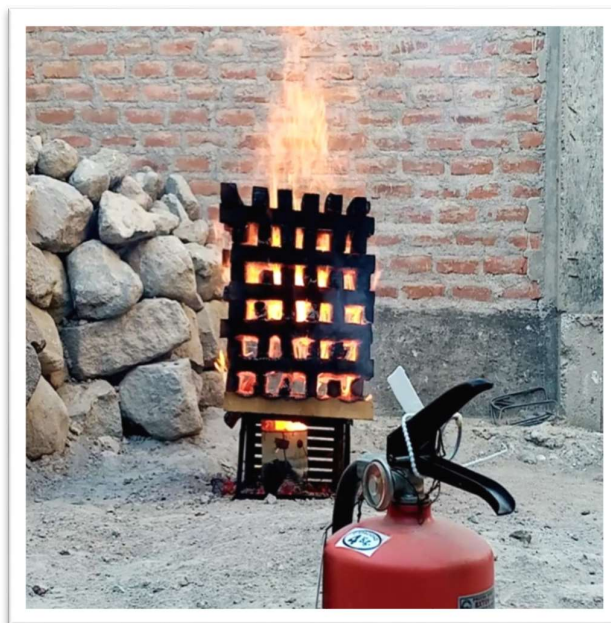
Figura 27: Previa a la utilización del extintor Prueba N°1
