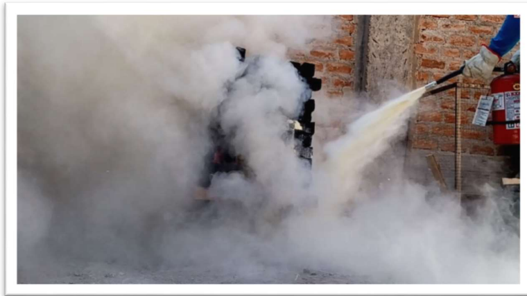
Figura 34: Extinción de incendio con extintor de PQS en Prueba N°2
