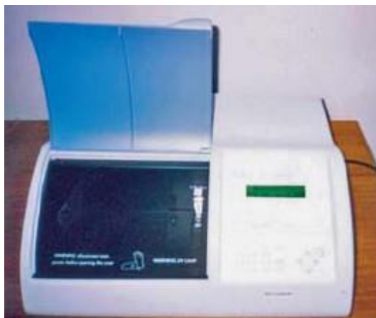
Figura 2. Espectrofotómetro ultravioleta para medir absorbancia de las muestras de aceite de oliva.
