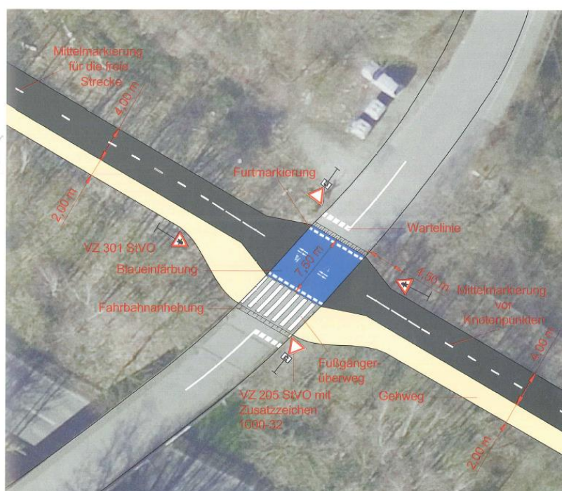
Abbildung 3.5 Prinzipskizze „Bevorrechtigte Querung“ (Quelle: Gestaltungshandbuch Radschnellwege, S. 211)
