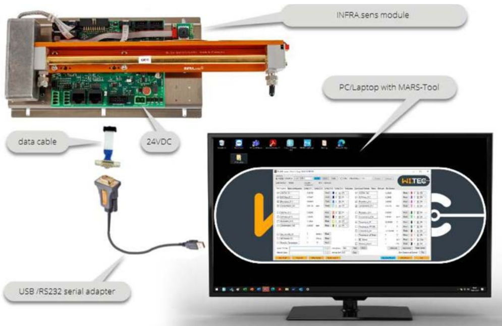
Abbildung 9: Übertragungsschema und Kommunikation zwischen Messgerät und MARS Software (Quelle: WITEC Sensorik)
