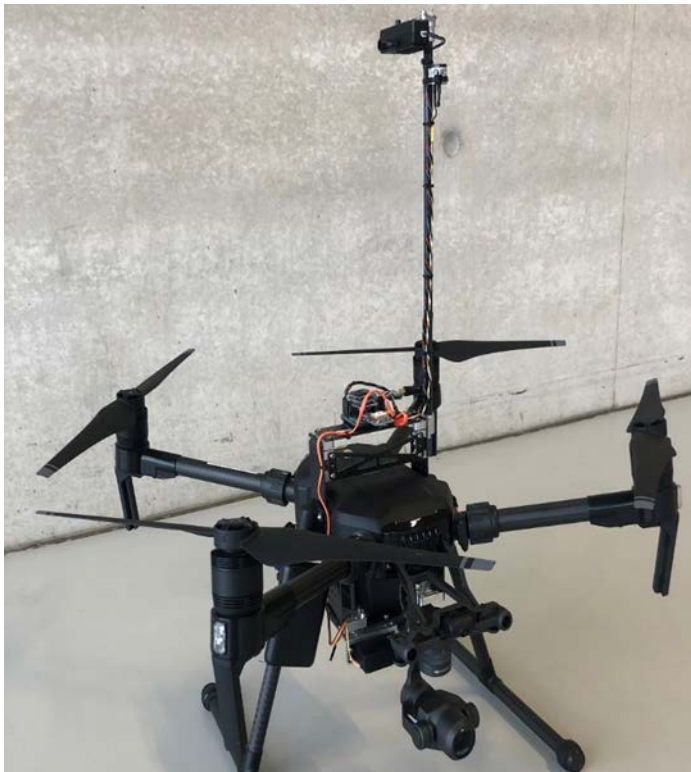
Abbildung 14: UMT-Sensorsystem mit angeschlossenem VOC-Sensor (Alphasense) auf einer DJI M200 Drohne
