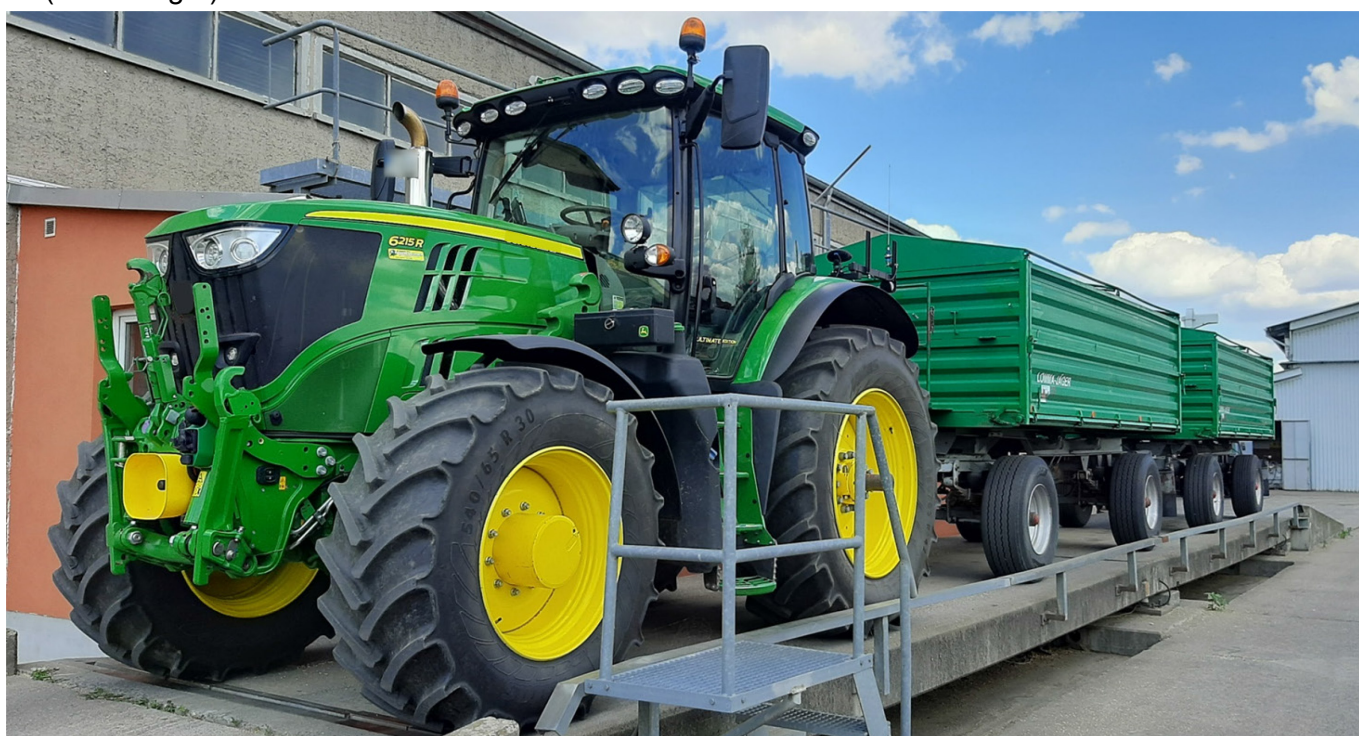
Abbildung 5: Fuhrwerkswiegung beim Landhändler
