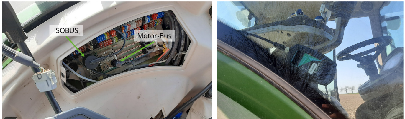
Abbildung 26: ISOBUS- und Motorbusschnittstelle (links) zwischen Maschine und Exatrek-T2-Modul (rechts)
