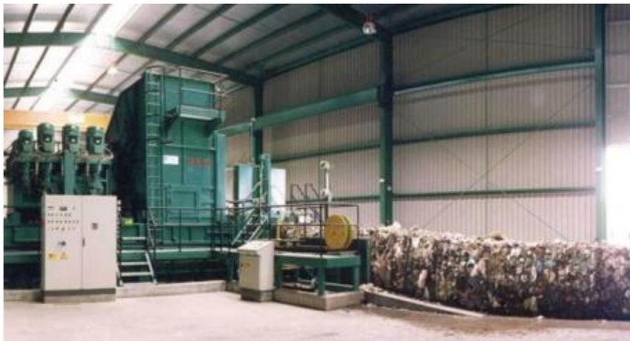
*Figura 2. 4 Planta de Pre-tratamiento de alta compactación*
