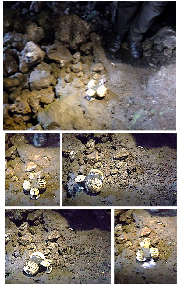
図7 小型ロボットの洞床走行実験 「YAOKI™」（株）ダイヤモンド
