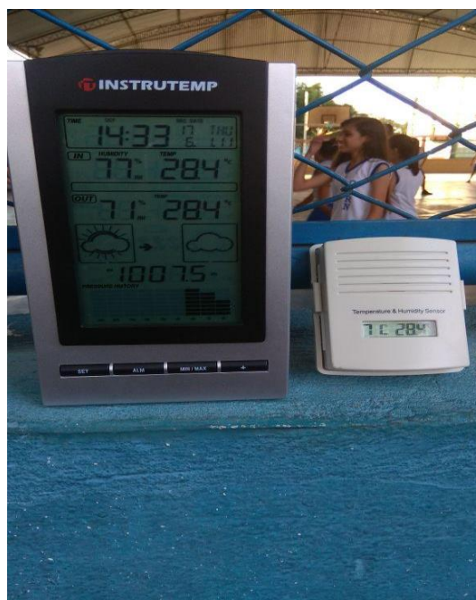
Figura 1. Termo higrômetro medindo dados de Umidade relativa e temperatura do ar no pátio do colégio São Raimundo em um dia de coleta de dados.
