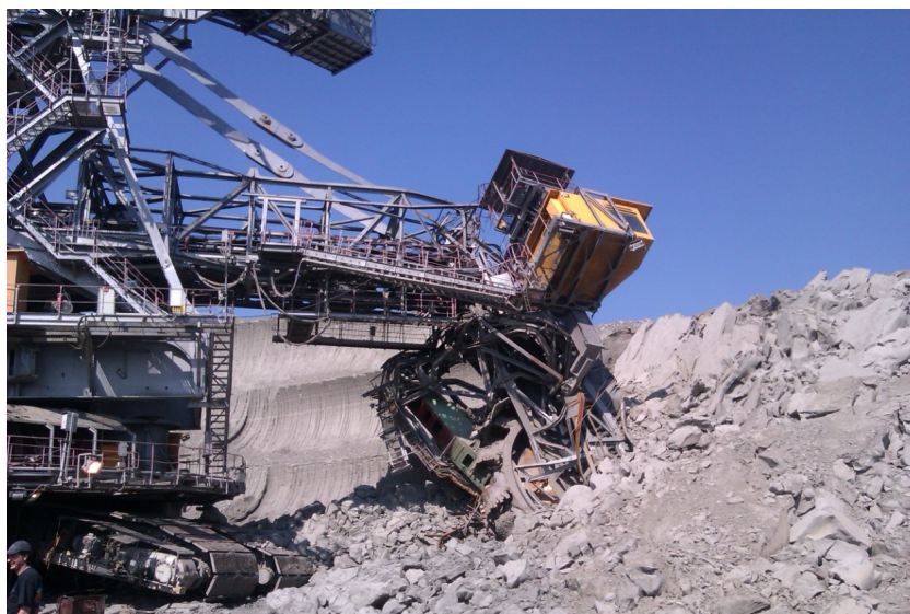
Slika 1. Izgled bagera nakon havarije
