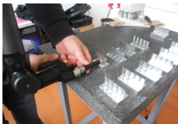
Slika 7. Mjerenje sa mjernim uređajem MCAx
