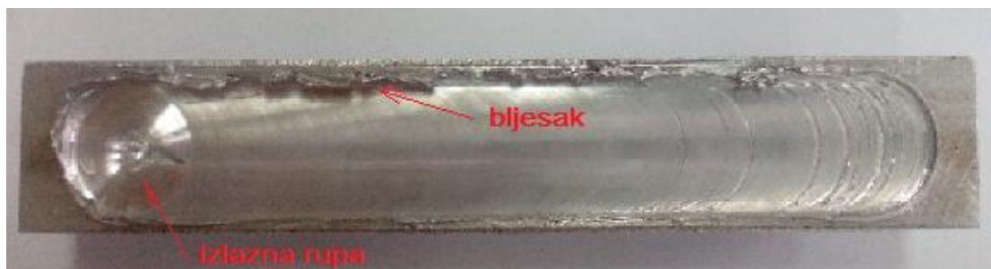
Slika 5. Fotografija lica metala šava
