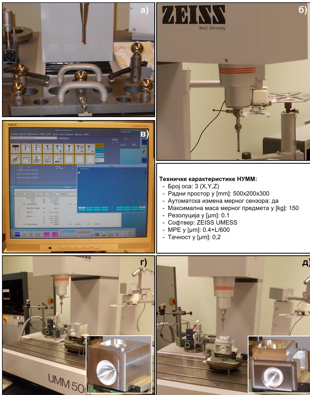
Слика 5. Експериментална инсталација за мерење два призматична мерна предмета
