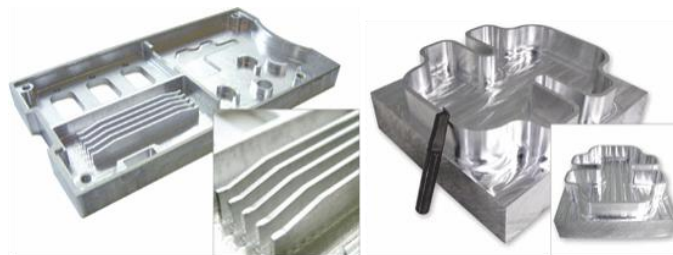
Slika 2. Složeni oblik tankostijenih aluminijumskih struktura
