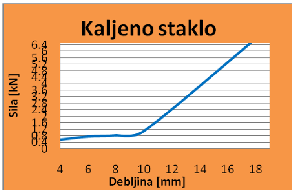
Slika 5. Sila u funkciji debljine kod kaljenog stakla
