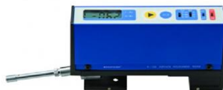
Slika 8. Uređaj za mjerenje hrapavosti INNOVATEST
