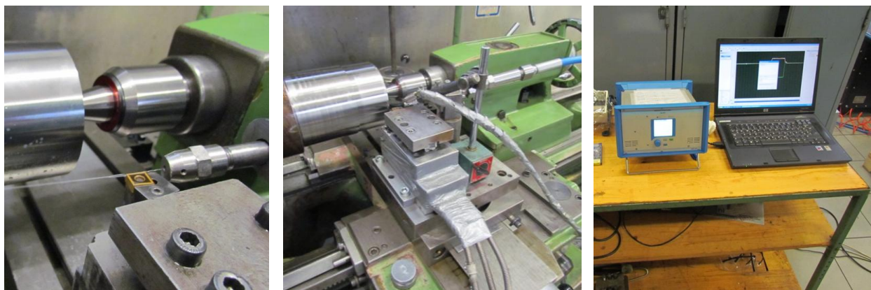
Slika 4. Postavka eksperimenta: mlaznica i inicijalni mlaz (lijevo), mašina (sredina) i mjerni lanac (desno)
