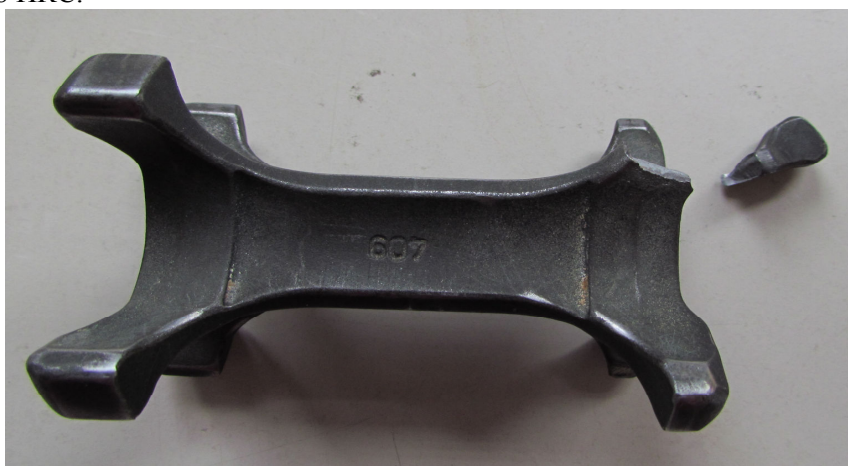
Slika 3.1 Zvezdasti separator nakon otkaza
