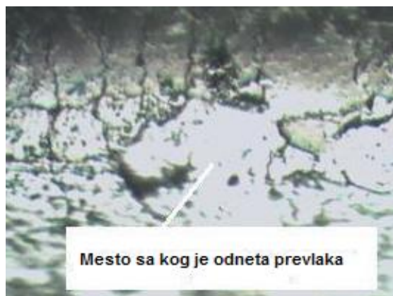
Slika 5. Scratch test na uzorku broj 7
