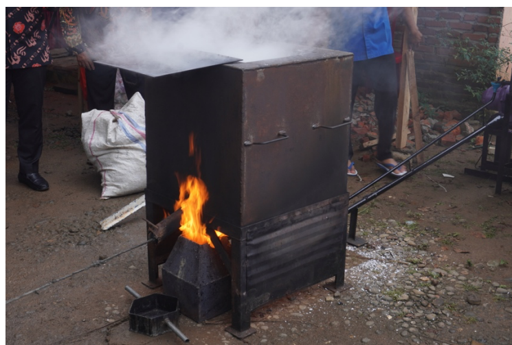
Gambar 3. Sampah plastik di dalam drum untuk dipanaskan dan dicairkan
