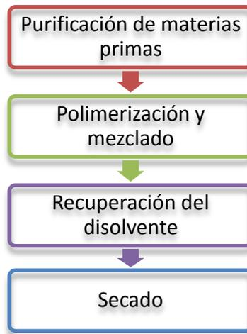
**Figura 12. Diagrama de bloques para la obtención de polidienos.**
