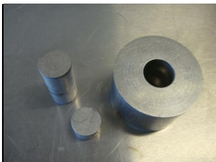
Figura 9. Soporte de acero inoxidable con diámetro de 22 mm.
