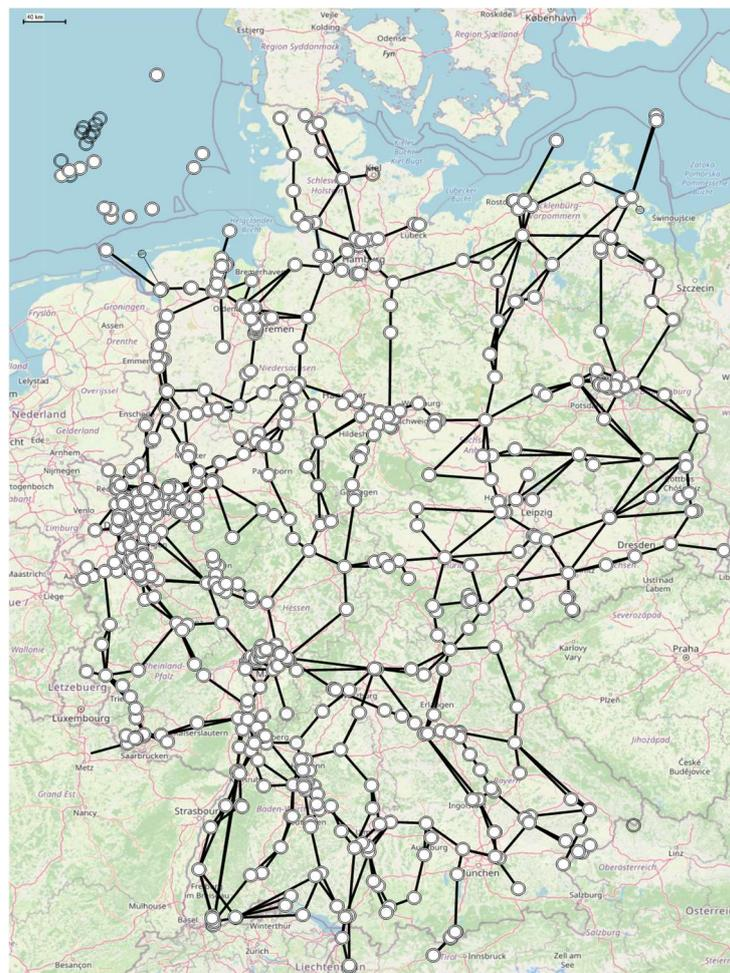
**Abbildung 13: Modell des deutschen Übertragungsnetzes nach der Georeferenzierung der Standorte. Die eingezeichneten Leitungen entsprechen nicht den tatsächlichen Trassenverläufen, da diese für die Leistungsflussberechnung irrelevant sind.**
