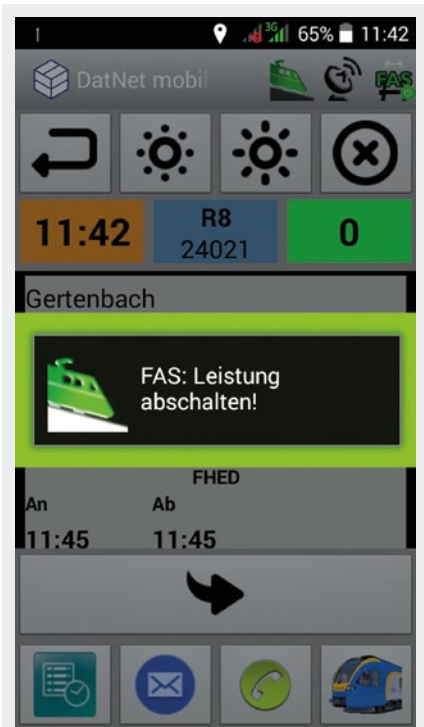
1: Fahrempfehlung „Leistung abschalten“ zum Ausrollen des Zuges Quelle: ETC Solutions GmbH
