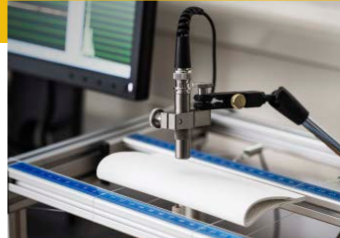
Ein Mikrofon zeichnet den Klang des schwingenden Leitschaufel-Modells auf.
