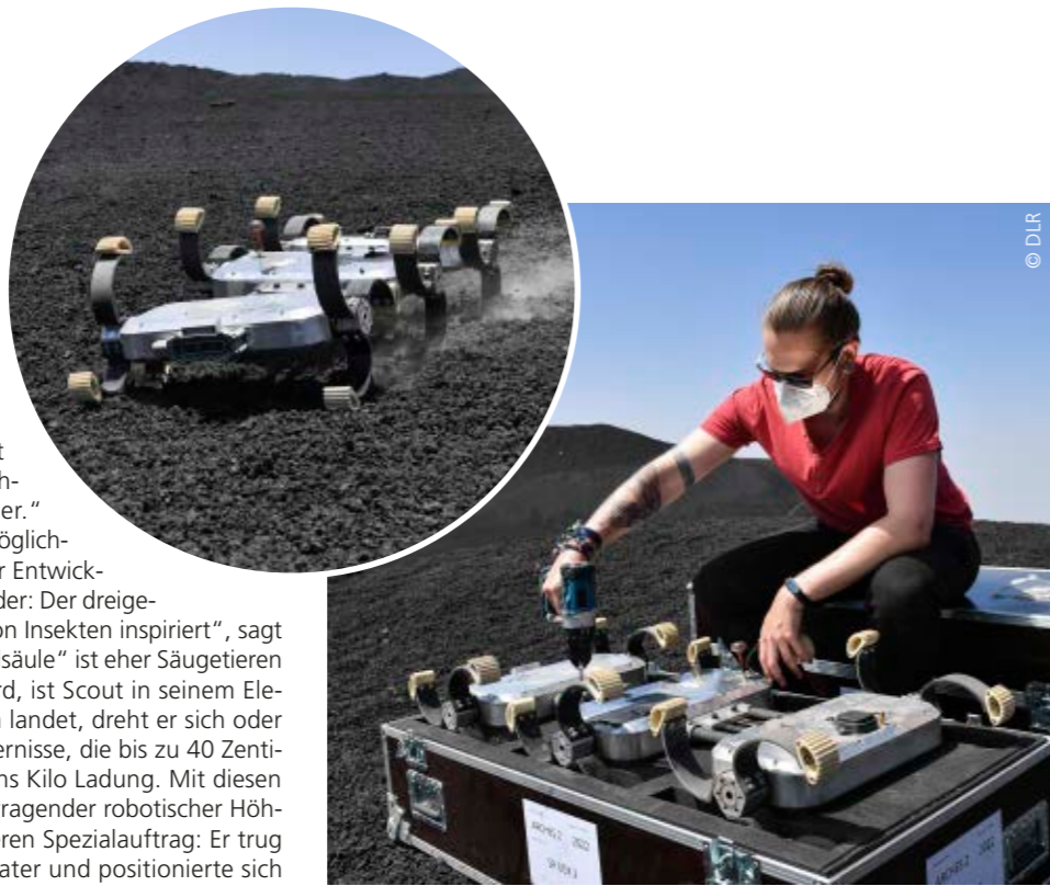
Sechs Beine mit jeweils drei Füßen lassen Scout hüpfen. Die Füße werden vorher entsprechend ausgestattet – je nachdem, auf welchem Untergrund sich der Roboter bewegt.
