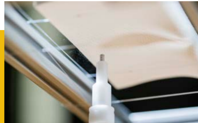
Ein Projektil tippt auf das Bauteil und versetzt es in Schwingung.
