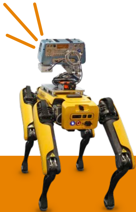
Das Integrated Positioning System (IPS DLR OS) des DLR, hier getragen vom Boston Dynamics Roboterhund SPOT, misst die innere Gebäude- und Raumgeometrie.
