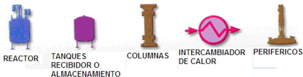
Fig. 8. Equipos de proceso principales en la industria farmoquímica
