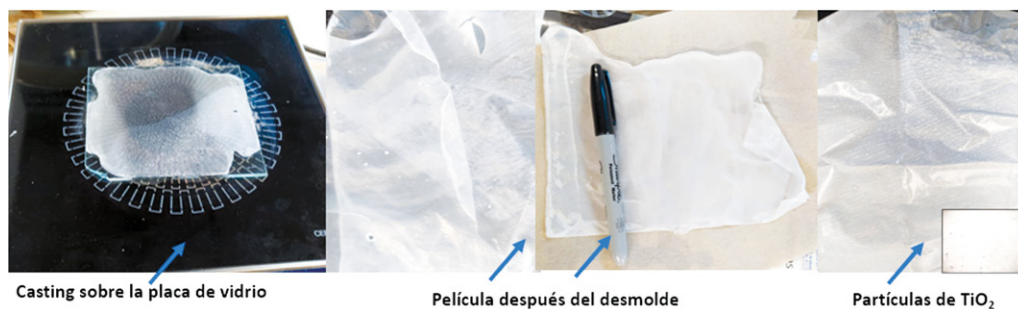
Figura 66. Proceso de casting hasta la obtención de las películas de PLA/TiO 2 -Zn/Bergamota
