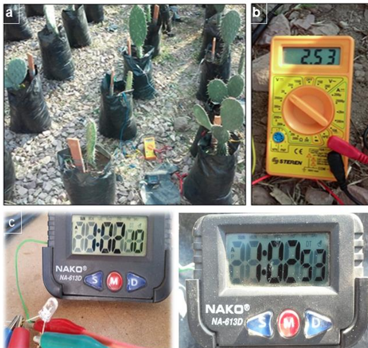
Figura 8. Prototipo alimentando LED y reloj digital. De izquierda a derecha: conexión de 12 P-MFC, multímetro monitoreando el voltaje y la aplicación en tiempo real de los dispositivos.
